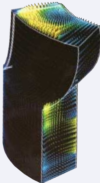
Hastighetsprofil gjennom viften.
